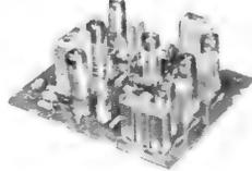
**BILD-ZF, TON-ZF, VIDEO- u. TON-ENDSTUFE**. Platine kpl. geschaltet enthält: Bild-ZF-Teil, Ton-ZF 5,5 MHz u. Tonendstufe. Röhren: EF183, 2 x EF 80 (1., 2., 3. Bild-ZF-Stufe), EBF 89, EF 80 (1. + 2. Ton-ZF-Stufe), PCL 86 (Tonendstufe), PCL 84 (Video-Endstufe). Kann leicht zum Umbau amerikanischer FS-Geräte verwendet werden mit Röhren **54.50** dito, ohne Röhren **33.50**
