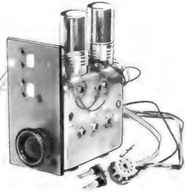
Zum Einbau in empfangsschwachen Gebieten. Der Anschluß erfolgt über einen Adapterstecker, der in den Sockel einer PCL 82 gesteckt wird. Der mechanische Einbau erfolgt an geeigneter Stelle an der Rückwand nach VDE-Bestimmung. Der UHF-Bereich wird auf Band I, Kanal 3 und 4, umgesetzt, Röhren: PC88, PC86. Der Einbausatz entspricht den Bedingungen der FTZ. Trotz des leichten Einbaues liegt genaue Einbauanweisung bei.
