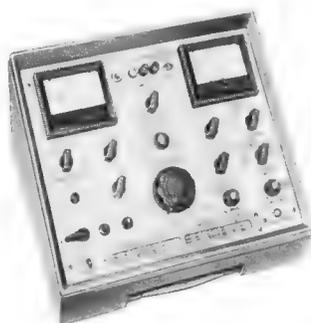
**HICKOK-Leistungstransistor-Tester** zum Prüfen besonders von Leistungs-Transistoren nach der Impulsmethode mit max. 100 V und 50 Amp. Impulsbreite regelbar für verschiedene Belastungsmessungen. Bestimmen lassen sich alle notwendigen NF-Parameter einschließlich der Sättigungsspannung und Durchbruchspannung.
