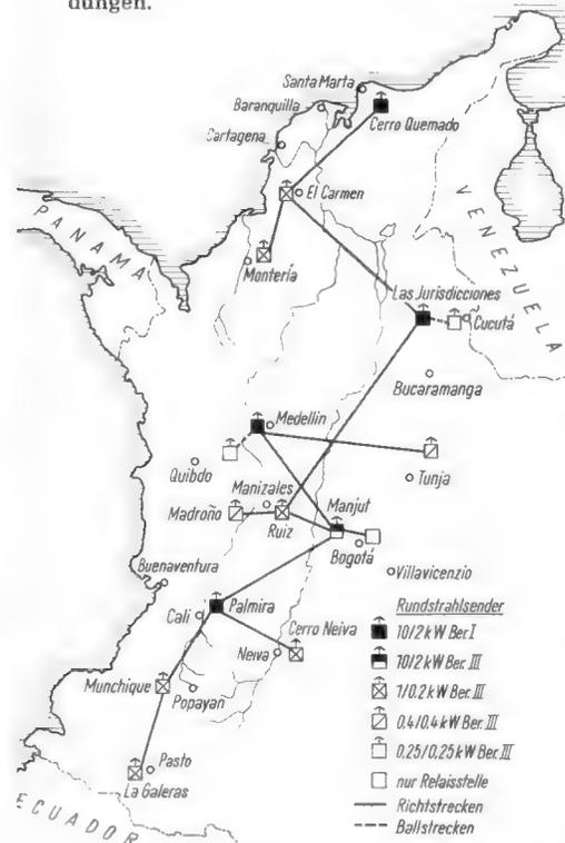
Bild 3. Plan des Fernsehernetzes von Kolumbien; die Strahler werden von Siemens geliefert. Anfang 1964 waren die Sender Manjui, Ruiz, Las Jurisdicciones, Monteria, El Carmen und Cerro Quemado bei Santa Marta fertig bzw. im Aufbau. Die Stationen liegen bis über 4000 m hoch, teilweise aber auch in Sumpfbereichen
