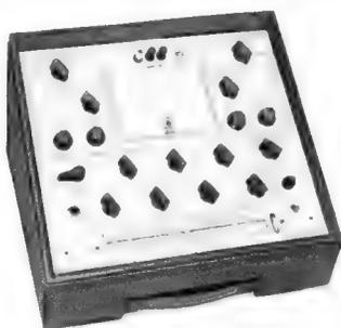
**HICKOK-Transistor-Tester Modell 1880:** Zur Bestimmung aller NF-Transistorparameter, besonders bei Silizium-Transistoren. Kleinster Meßbereich für Restströme ist 0,05 Mikro-Amp.-Vollausschlag. Kollektorstrom max. 3 Amp., Kollektorspannung max. 10 V, Gleich- und Wechselstrom-Meßbereich für Beta 50, 150, 300 und 1000 (Vollausschlag).
