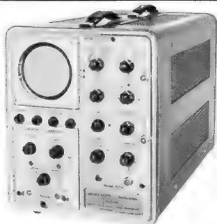
**HUGHES-MEMO-SCOPE®-Oszillograph:** Ein SPEICHER-Oszillograph in Einschubtechnik mit höchster Schreibgeschwindigkeit bei Speicherung: 2 500 000 cm/sek.! 3 verschiedene Verstärkereinschübe stehen zur Verfügung. Speicherung der einmaligen Vorgänge auf dem Schirm von nahezu unbegrenzter zeitlicher Dauer. Löschzeit kürzer als 150 msek. Auch als normaler Oszillograph mit einer Bandbreite bis zu 10 MHz verwendbar.
